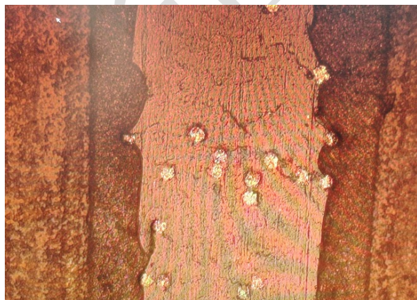
200X 导电粒子爆破形状 (菲林)
