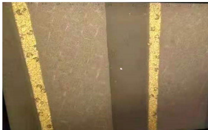
200X 导电粒子爆破形状 (菲林)
